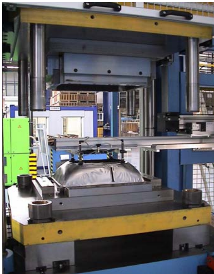
Volledige productielijn (3 persen + 3 interpress manipulatoren) Ligne de production (3 presses et 3 manipulateurs) Production line (3 presses + 3 manipulators) Fertigungsstraße mit 3 Pressen und 3 Interpress Manipulatoren
