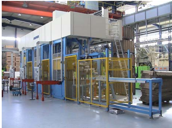
Volledige productielijn (3 persen + 3 interpress manipulatoren) Ligne de production (3 presses et 3 manipulateurs) Production line (3 presses + 3 manipulators) Fertigungsstraße mit 3 Pressen und 3 Interpress Manipulatoren
