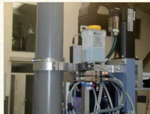
Lubrification par fumée d'huile
